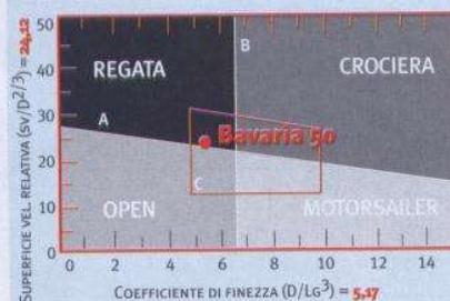
**LEGENDA:** A-B: più uno scafo si allontana da queste due linee e più presenta le caratteristiche di uno dei quattro settori colorati. C: trapezio che contiene il 70% della flotta. SUPERFICIE VELICA RELATIVA: valore alto = barca molto invelata in rapporto al suo peso. COEFFICIENTE DI FINEZZA: valore basso = barca leggera - valore alto = barca pesante.
