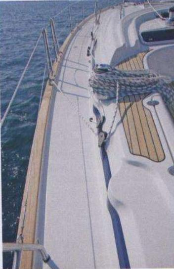
Sopra, i passavanti sono ampi sia a centro barca che a poppa; pratica e sicura la falchetta strutturale alta quasi 5 cm. A sinistra, il tavolo con le ante chiuse lascia un agevole passaggio all'interno del pozzetto. Il diametro delle ruote, rivestite in pelle, è di 100 cm.
